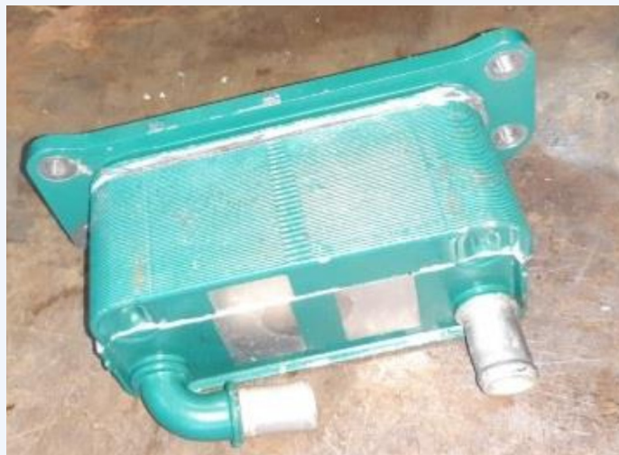
Slika 4: Hladnjak ulja za podmazivanje (pločasti / lamelasti)
