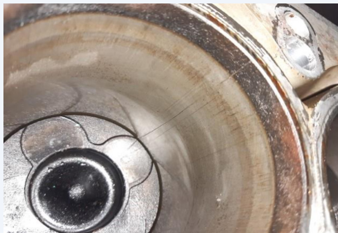
Slika 5: Oštećenja na košuljicama cilindra br. 2 i 3
