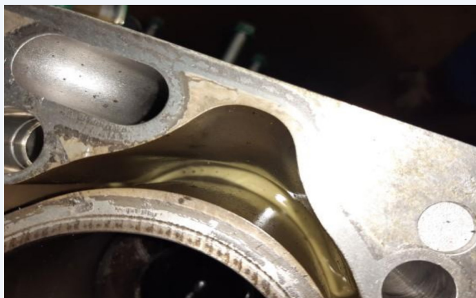
Slika 2: Mješavina ulja i rashladnog medija u rashladnim kanalima bloka motora
