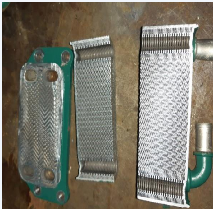
Slika 6: Otvoreni ("raspilani") hladnjak ulja za podmazivanje
