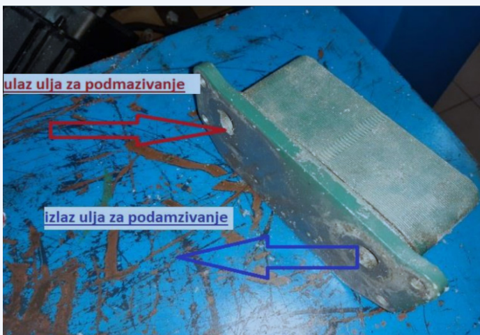
Slike 7 i 8: Otvoreni ("raspilani") hladnjak ulja za podmazivanje
