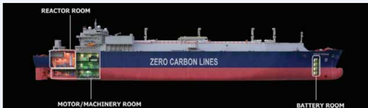
Slika 2. Smještaj prostorije na brodu za prijevoz ukapljenog prirodnog plina na nuklearni pogon
