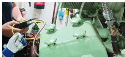
Slika 5.5.2 Mjerenje sa uređajem Maridis MarPrime Ultra na dizel motoru RB&W Alpha Dizel 14V23L-VO
