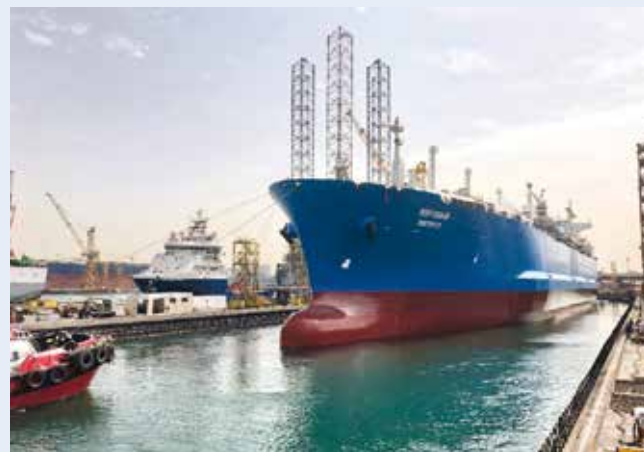
SLIKA 4. Izlazak LNG tanker s ojačanjem na lijevoj strani trupa broda iz doka
