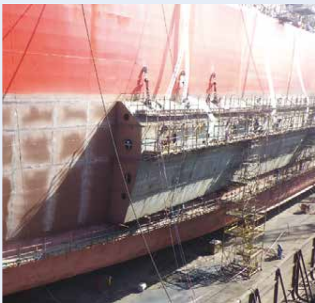
SLIKA 3. Zavarivanje sekcija ojačanja na trup broda u suhom doku
