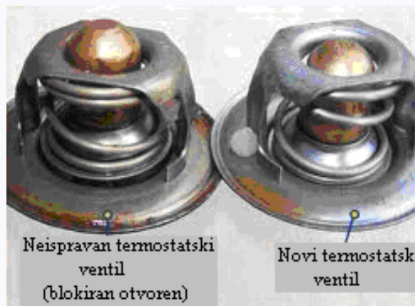
Slika 2 - Usporedba termostatskih ventila
