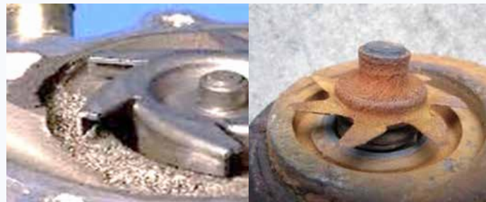
Slika 3 - Oštećenja pumpi rashladnog sustava
