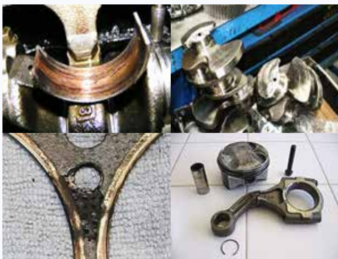
Slika 10 - Uzrok i posljedice hidrauličnog udara
