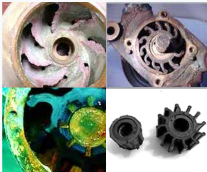
Slika 6 - Primjeri kvarova pumpe morske vode
