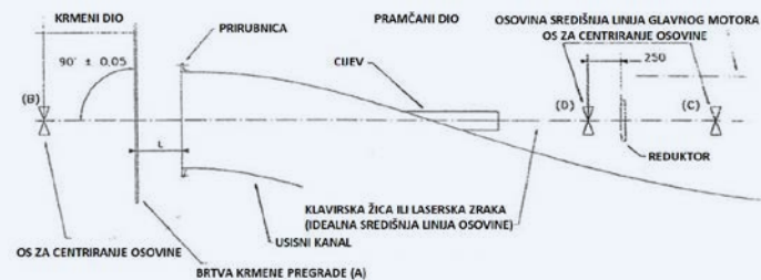
SLIKA 4. Idealna središnja linija osovine vodenog mlaza
