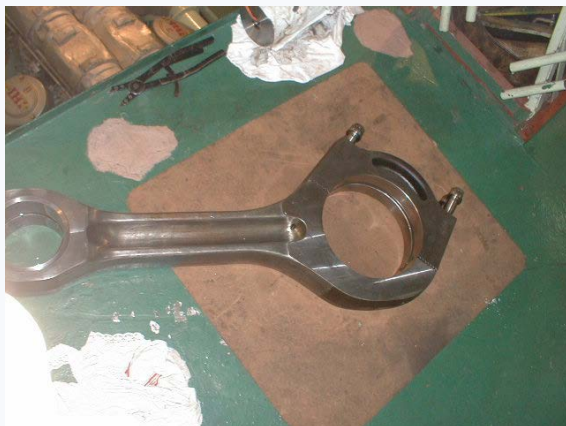
Slika 4 - prikazuje klipnjaču kompletiranu sa vijcima bez ležaja. Ovo je pozicija za promjeru ovalnosti.
