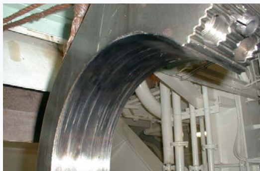
Slika 2 - prikazuje oštećenje klipnjače uzrokovane zakretanjem šalica ležaja tijekom rada, oštećena je i nazubljena kontaktna površina između klipnjače i poklopca ležaja
