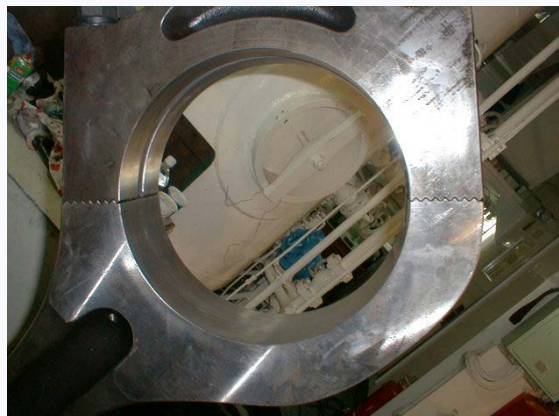
Slika 6 – Reparirana klipnjača spremna za montažu
