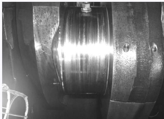
Slika 3 - prikazuje oštećeni osnjak glavne osovine na poziciji cilindara br. 4 i 9
