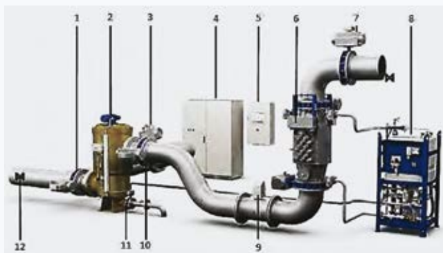
SLIKA 1. Glavne komponente sustava za obradu balastnih voda
